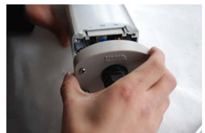
2, 将侧盖拉开, 露出内部接线端子
